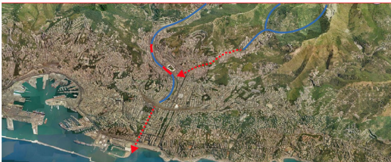
Mappa dei tratti coperti (in rosso) dei torrenti Bisagno e Rio Fereggiano
